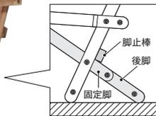
固定脚と脚止棒が後脚を固定する事でチェア全体の動きを制限する
